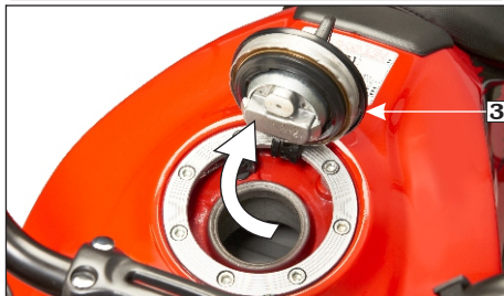
(3) Tapa del tanque de combustible
