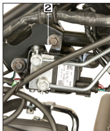
(1) Sensor de velocidad de la rueda (2) Unidad de Control Electrónico Hidráulico (HECU)
